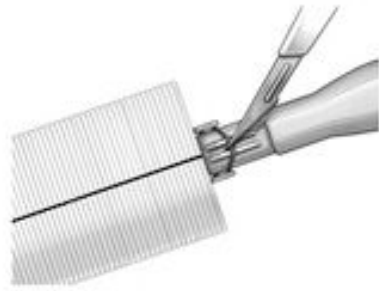
Rysunek 11: Rowek w uchwycie służący do zwolnienia wyrobu przez pojedyncze przecięcie szwu
