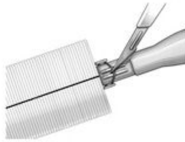
Abbildung 11: Kanal im Halter, der das Lösen durch einen Schnitt möglich macht
