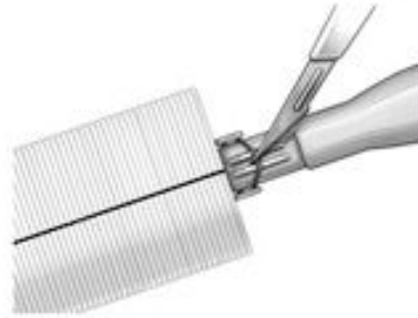
Afbeelding 11: Kanaal waarmee het hulpmiddel met één snede uit de houder kan worden gehaald in houder
