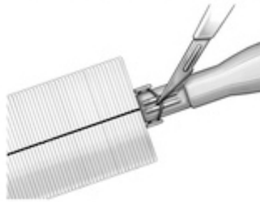
Figure 11: Single-cut Release Channel in Holder ■ Figura 11: Canal de liberación de un solo corte en el soporte ■ Figura 11: Canal de liberação com corte único no suporte
