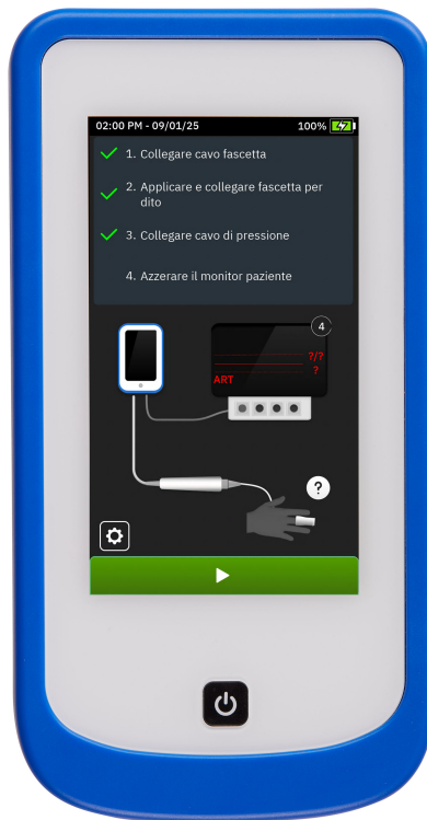
Figura 4-2: Istruzioni di collegamento del modulo HemoSphere Stream™ indicate sullo schermo
