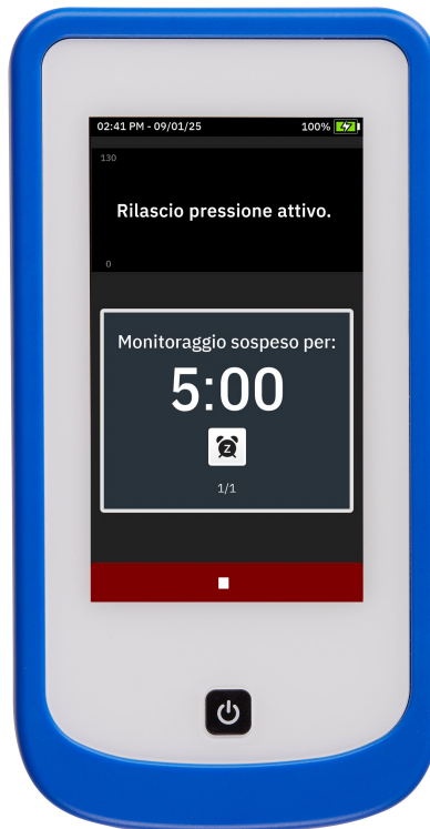
Figura 4-8: Rilascio pressione fascetta del modulo HemoSphere Stream™ attivo
