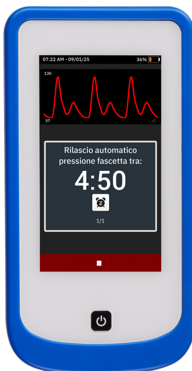
Figura 4-7: Notifica del rilascio imminente della pressione fascetta del modulo HemoSphere Stream™
