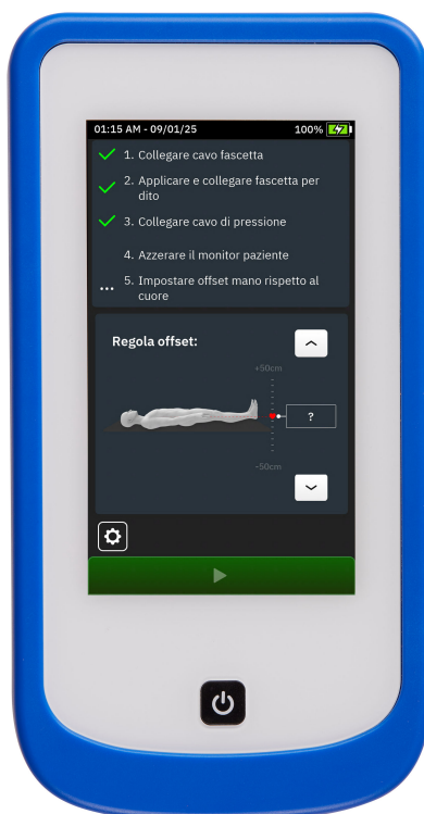
Figura 4-5: Istruzioni di collegamento del modulo HemoSphere Stream™ indicate sullo schermo
