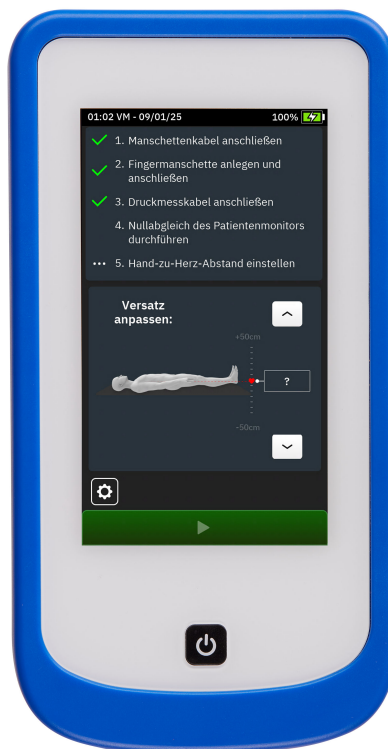
Abbildung 4-5: Bildschirmanweisungen zum Anschluss des HemoSphere Stream™ Moduls
