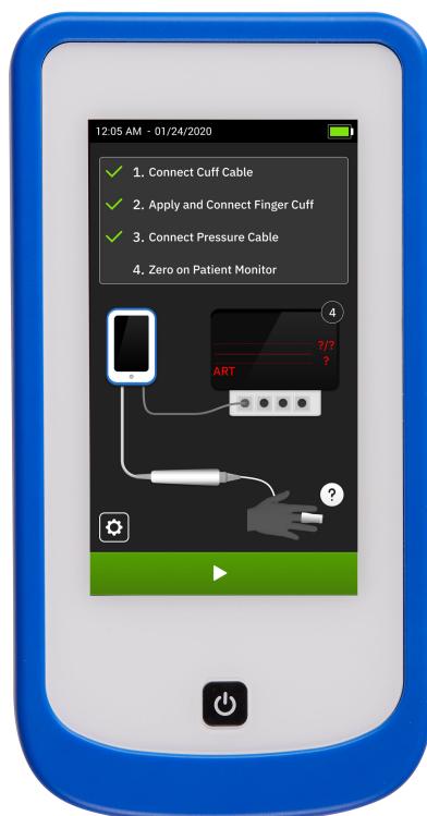
Рис. 4-2. Экранные инструкции по подключению модуля HemoSphere Stream™
