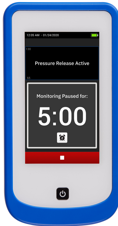
Рис. 4-8. Активный сброс давления в манжете модуля HemoSphere Stream™
