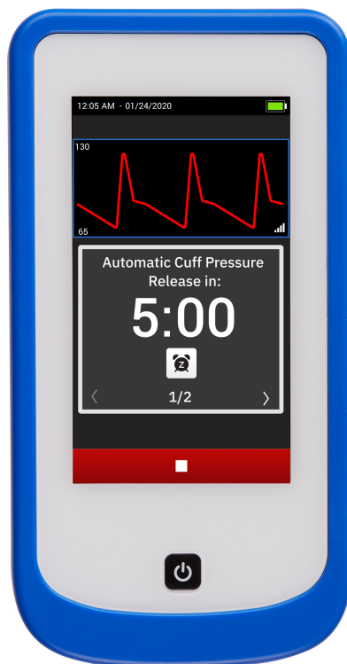
Рис. 4-7. Уведомление о предстоящем сбросе давления в манжете модуля HemoSphere Stream™
