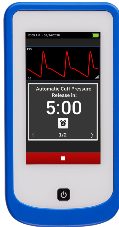
Figura 4-7: Notificare pe modulul HemoSphere Stream™ pentru următoarea eliberare a presiunii din manșetă
