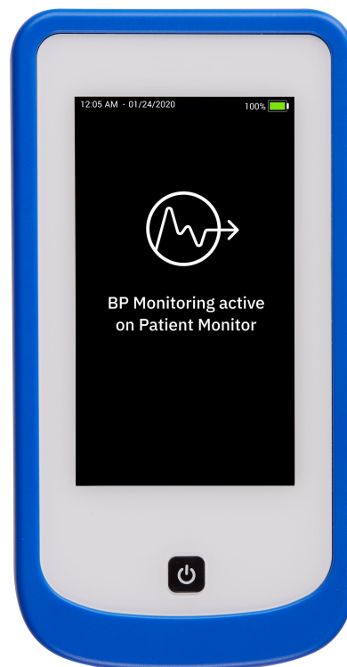
Figura 4-10: Ecranul modului de economisire a energiei pe modulul HemoSphere Stream™
