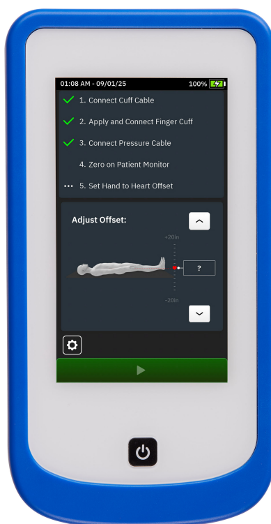
Figura 4-5: Instrucțiuni pe ecran pentru conectarea modului HemoSphere Stream™
