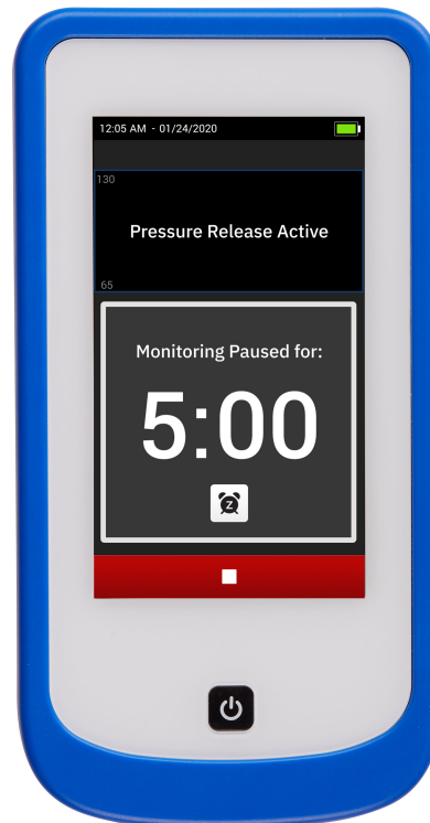
Figura 4-8: Eliberare activă a presiunii din manșetă pe modulul HemoSphere Stream™
