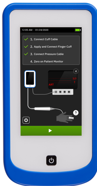
Figura 4-2: Instrucțiuni pe ecran pentru conectarea modului HemoSphere Stream™
