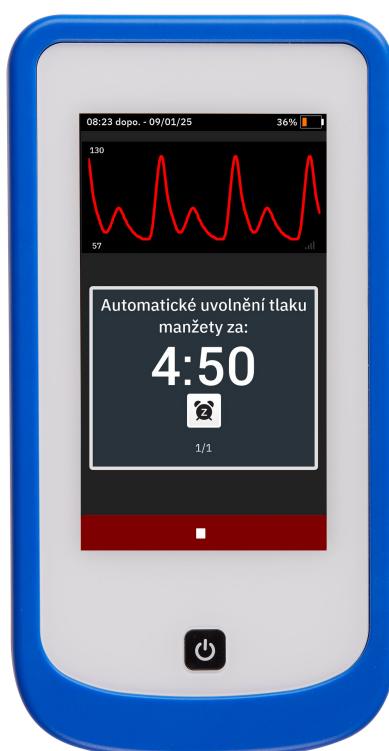
Obrázek 4-7: Oznámení modulu HemoSphere Stream™ o nadcházejícím uvolnění tlaku manžety
