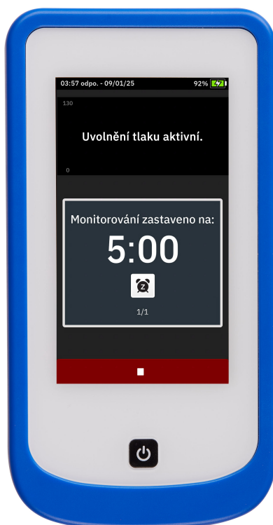
Obrázek 4-8: Právě probíhající uvolnění tlaku manžety modulu HemoSphere Stream™
