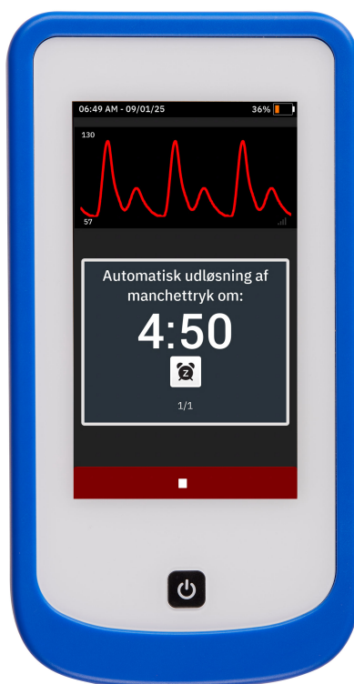
Figur 4-7: Meddelelse om kommende udløsning af manchetryk i HemoSphere Stream™ modulet
