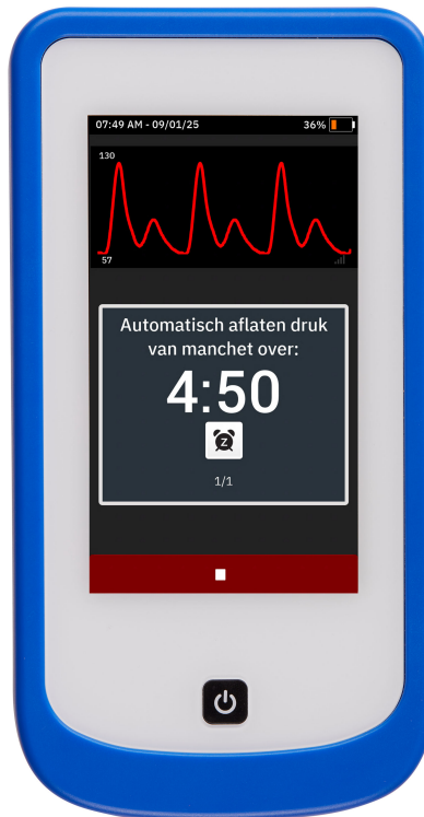
Afbeelding 4-7: Melding op de HemoSphere Stream™-module van aankomend aflaten van druk van de manchet
