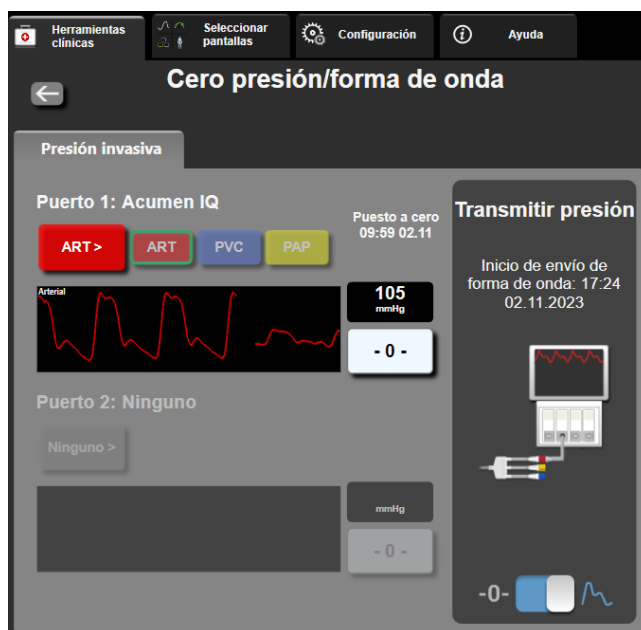
Figura 10-2: Pantalla de cero presión/forma de onda de presión: sensor de cero presión y de salida de presión
