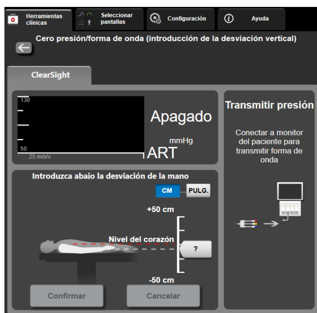
Figura 11-6: Pantalla Cero presión/curva presión: introducción de la desviación vertical
