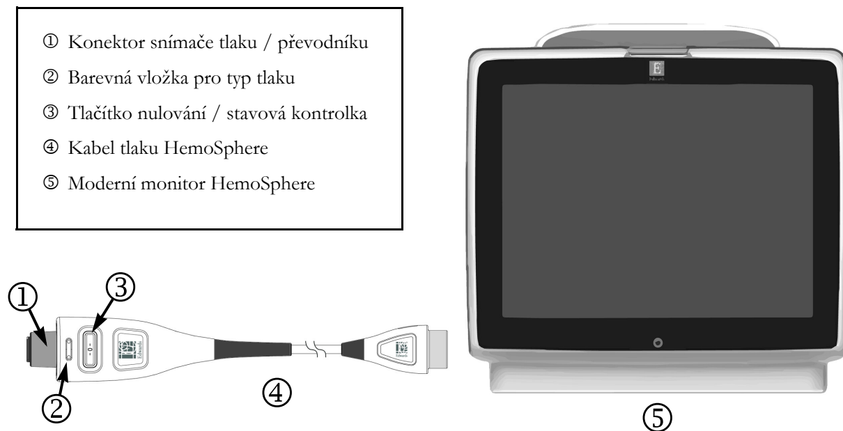
Obrázek 4-2 Přehled připojení kabelu tlaku
