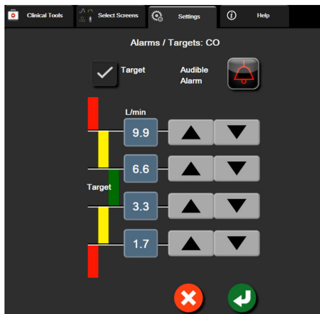
Figura 7-2: Setare alarme și ținte pentru parametrii individuali
