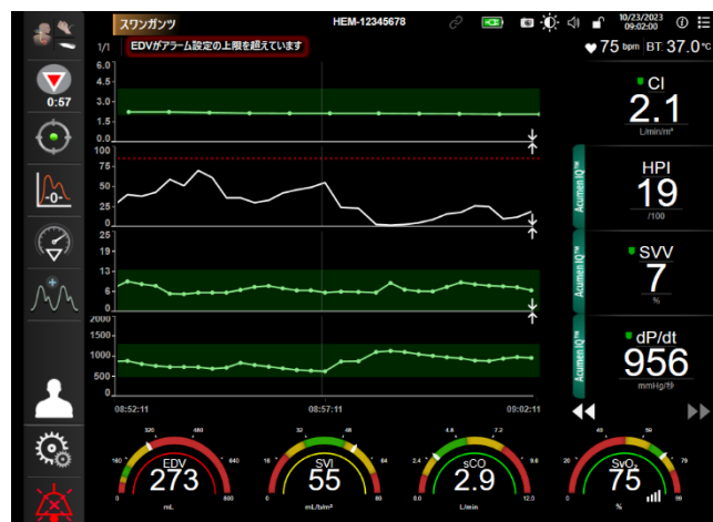
図 9-9 メインモニタリングビュー -スワンガンツモジュールモニタリングでの Acumen IQ センサの使用
