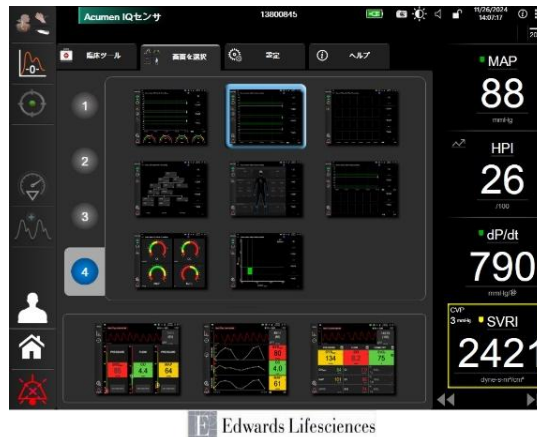
図 5-3 モニタリング画面選択ウィンドウの例
