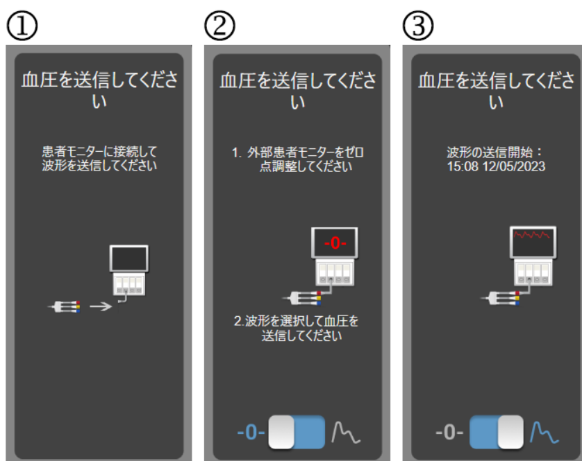
図 11-10 動脈圧波形の患者モニターへの送信
