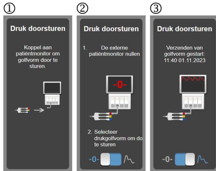
Afbeelding 11-10: Stuur arteriële drukgolfvorm door naar patiëntmonitor
