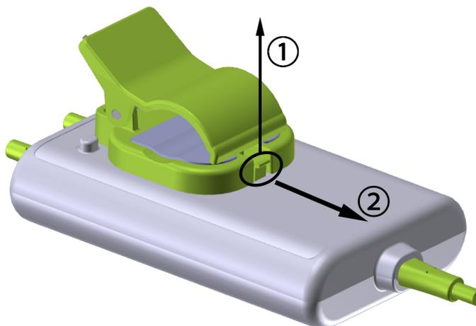
Figure 13-7 : Retrait du clip de fixation
