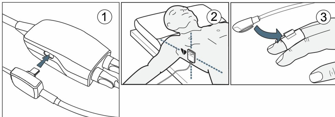
Figure 11-4 : Installation du capteur de référence cardiaque
