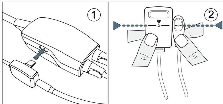
Figure 11-7 : Étalonner le capteur de référence cardiaque
