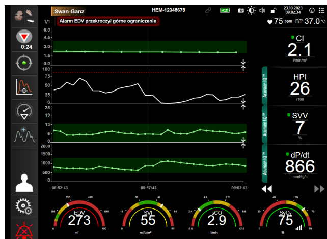
Rysunek 9-9: Główny widok monitorowania — monitorowanie za pomocą modułu Swan-Ganz czujnikiem Acumen IQ
