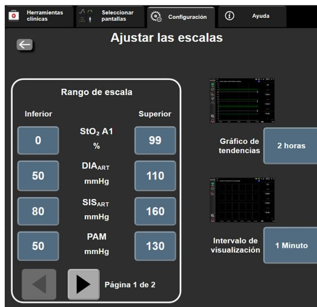
Figura 7-4: Ajuste de las escalas
