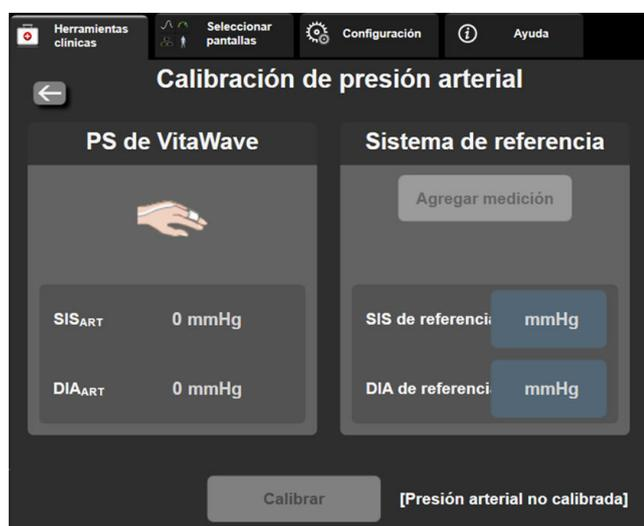
Figura 9-9: Pantalla de calibración de presión arterial
