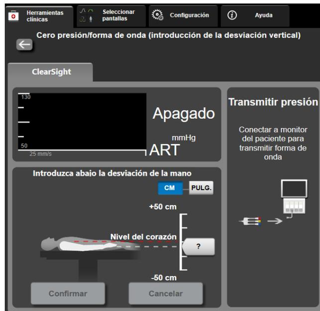
Figura 9-6: Pantalla Cero presión/curva presión: introducción de la desviación vertical
