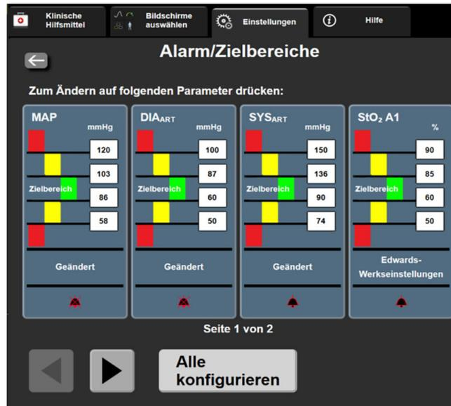
Abbildung 7-1: Konfiguration der Alarme/Zielbereiche
