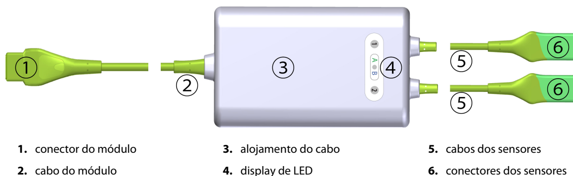
Figura 13-1: Visão frontal do cabo de oxímetro ForeSight
