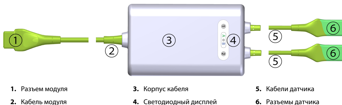
Рис. 13-1. Оксиметрический кабель ForeSight — вид спереди
