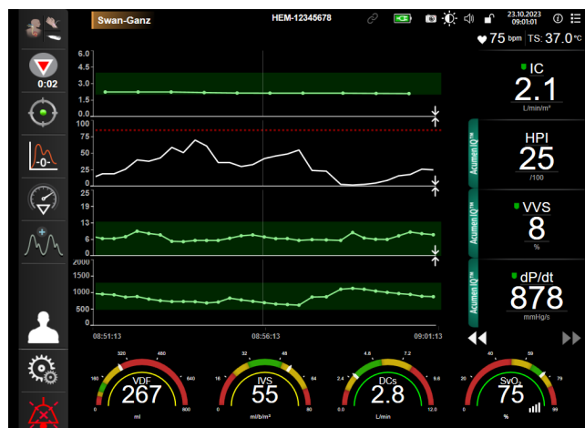
Figura 9-9: Visualização principal de monitoramento — monitoramento com módulo Swan-Ganz com um sensor Acumen IQ
