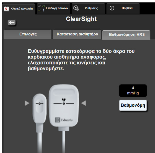
Εικόνα 11-8: Οθόνη βαθμονόμησης HRS
