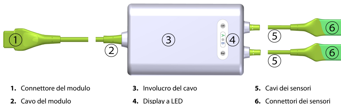
Figura 13-1: Vista frontale del cavo per ossimetro ForeSight
