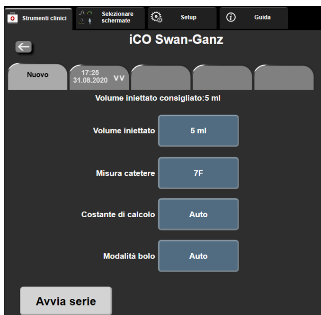
Figura 9-6: Schermata di configurazione Nuova serie iCO
