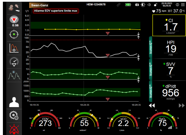
Figura 9-9: Vista di monitoraggio principale: monitoraggio con il modulo Swan-Ganz con un sensore Acumen IQ
