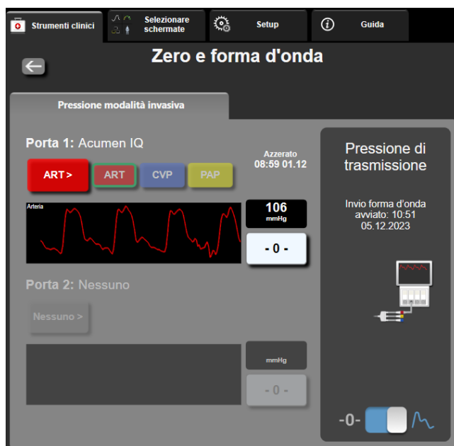
Figura 10-2: Schermata Zero e forma d'onda: azzeramento sensore e pressione di uscita
