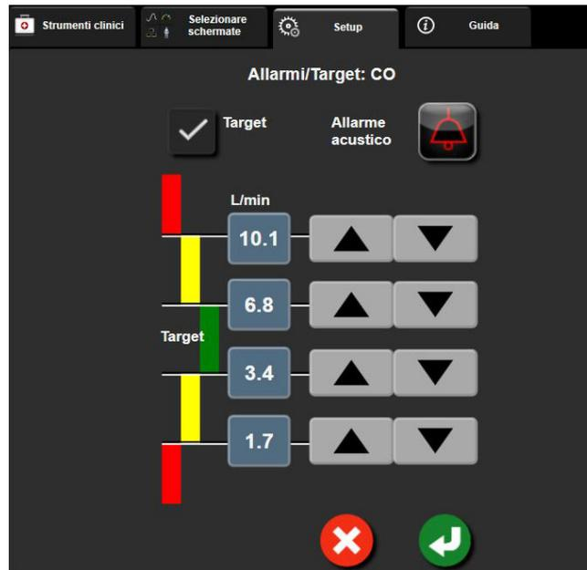
Figura 7-2: Impostazione di allarmi e target per parametri singoli
