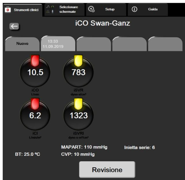
Figura 9-7: Schermata di riepilogo della termodiluzione
