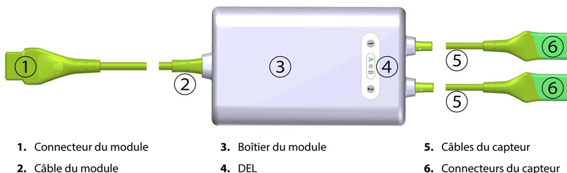
Figure 13-1 : Vue avant du module d'oxymétrie FORE-SIGHT ELITE
