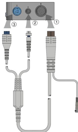
Figure 9-2 : Connexions de test du câble CCO patient
