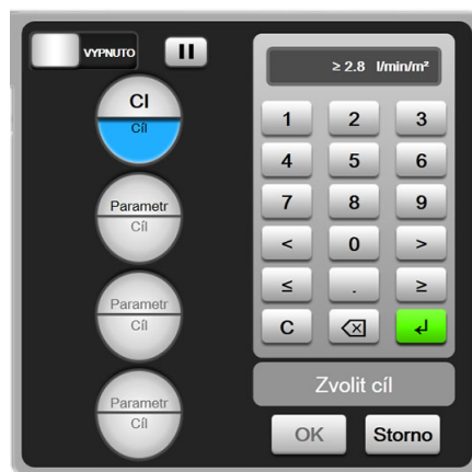
Obrázok 13-9 Obrazovka ponuky GDT – výber cieľa
