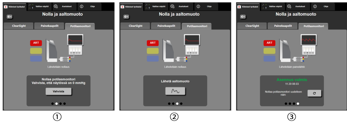
Kuva 11-8: Valtimopaineen aaltomuodon lähettäminen potilasmonitoriin
