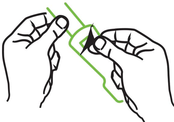
Figura 13-10: Rimozione della pellicola protettiva dal sensore
