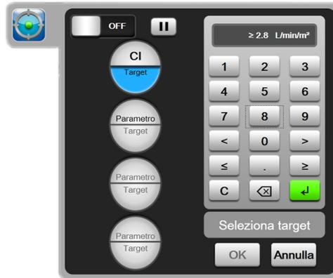
Figura 14-11: Schermata del menu GDT - Selezione del target
