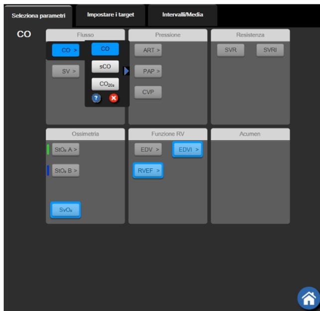
Figura 9-3: Finestra di selezione dei parametri chiave del modulo HemoSphere Swan-Ganz
