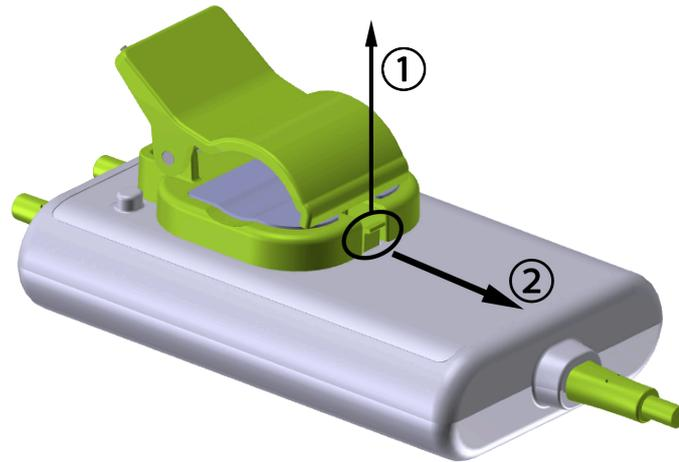
Figura 13-7: Extracción del clip de montaje
