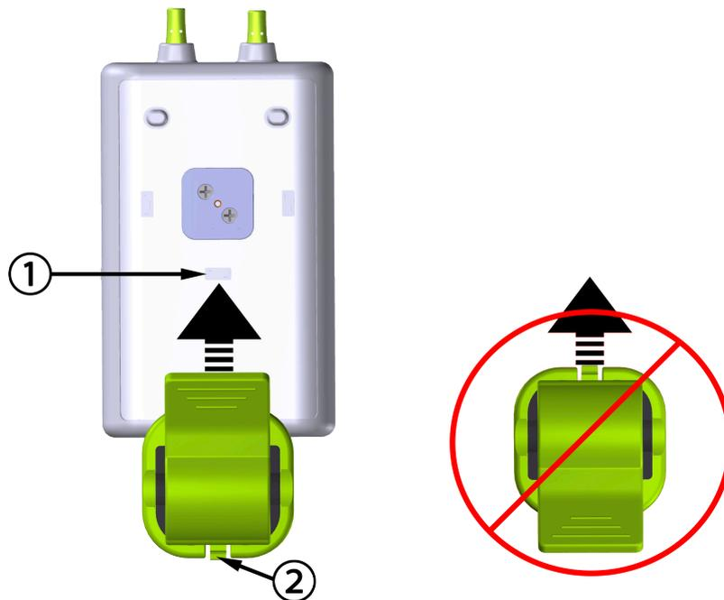
1. ranura de sujeción del clip de montaje (vertical)
