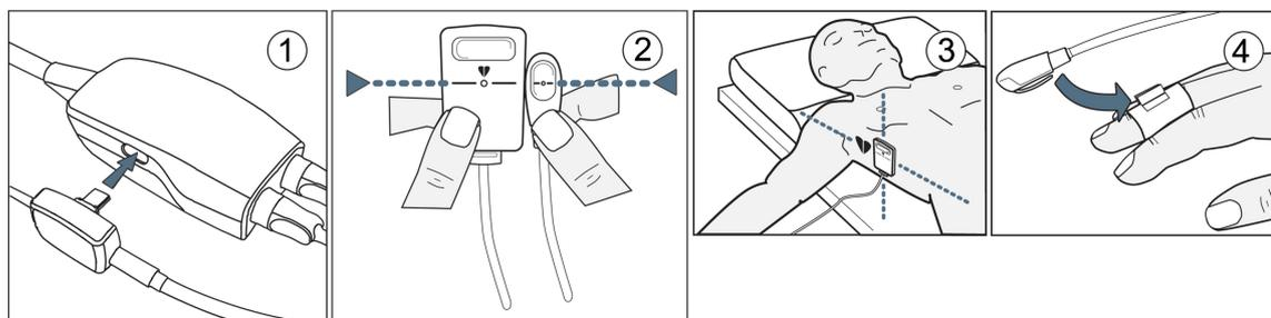
Figura 11-4: Colocación del sensor de referencia del corazón
