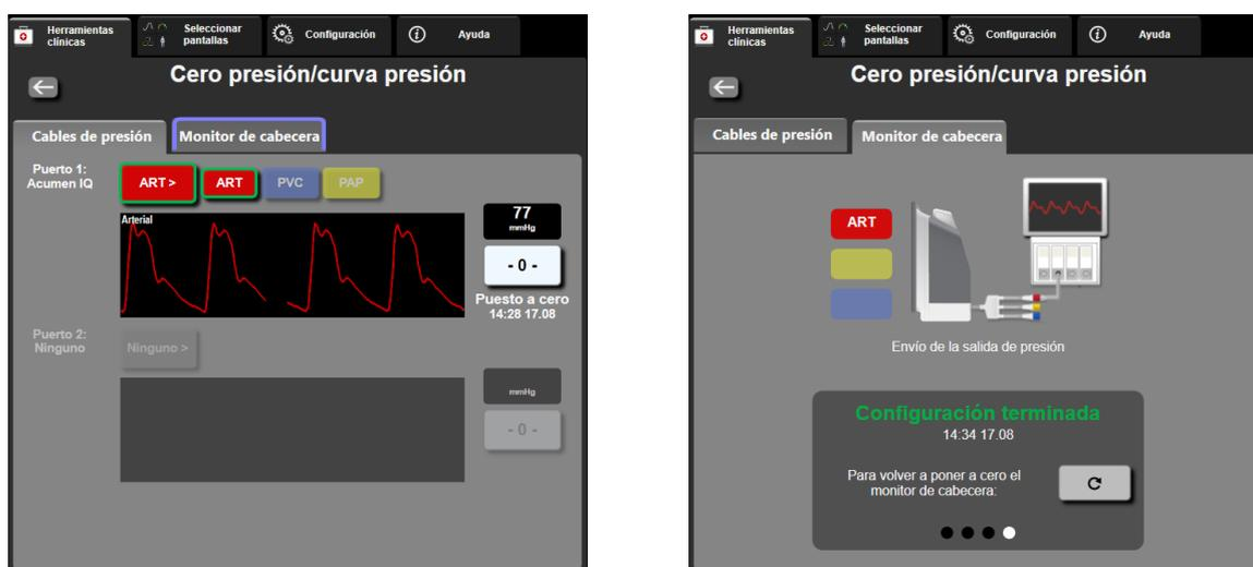
Figura 10-2: Pantallas de cero presión/forma de onda de presión: sensor de cero presión y de salida de presión
