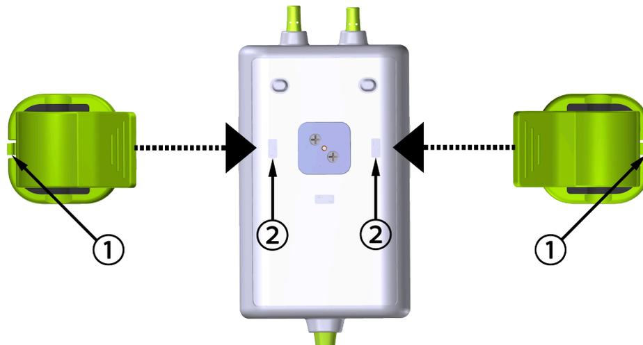
1. pestaña de sujeción del clip de montaje
