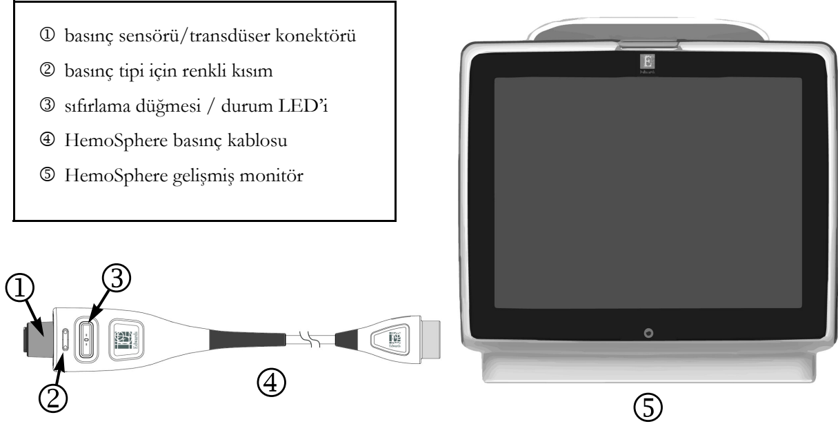
Şekil 4-2 Basınç kablosu bağlantısına genel bakış
