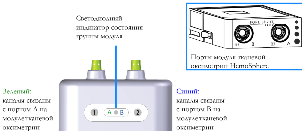
Рис. 12-9 Светодиодные индикаторы состояния модуля ForeSight Elite
