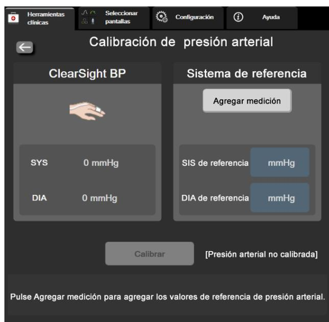
Figura 11-7: Pantalla de calibración de PS
