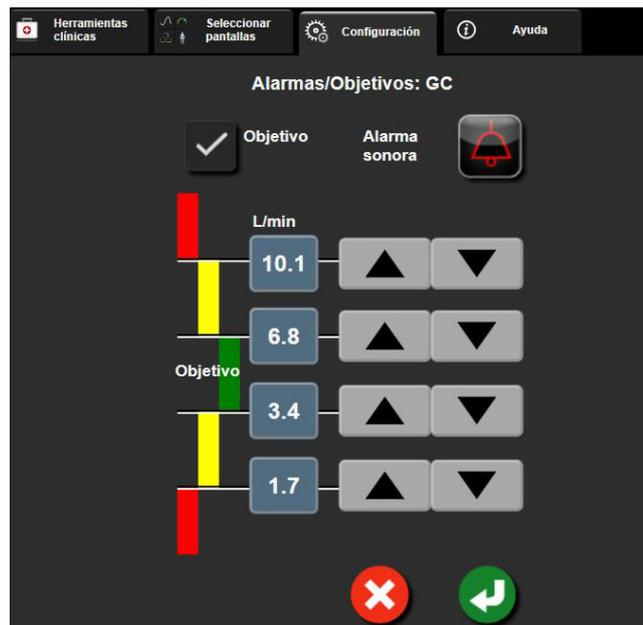
Figura 7-2: Configuración de las alarmas y objetivos para un parámetro individual
