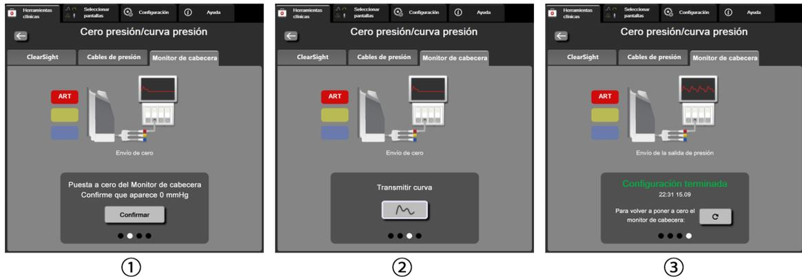
Figura 11-8: Transmisión de la forma de onda de presión arterial al monitor de cabecera
