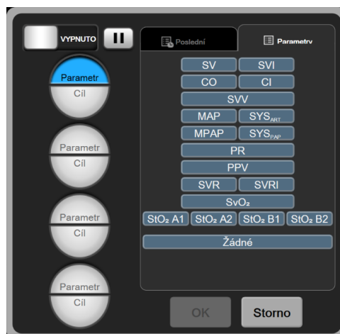
Obrázek 14-8: Obrazovka nabídky GDT – Volba klíčových parametrů
