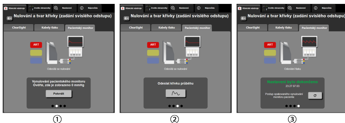
Obrázek 11-8: Přenos křivky arteriálního tlaku na monitor pacienta
