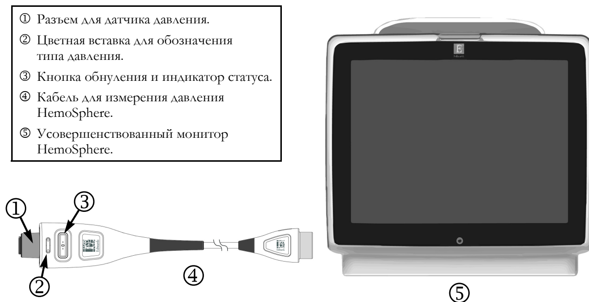
Рис. 4-2 Обзор соединений кабеля давления
