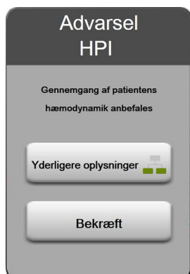
Figur 12-5 Pop op-vindue med advarsel om højt HPI
