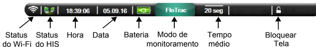
**Figura 5-20 Barra de informações - Cabo de pressão HemoSphere**
