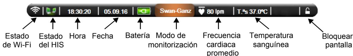
**Figura 5-19 Barra de navegación: módulo Swan-Ganz de HemoSphere**
