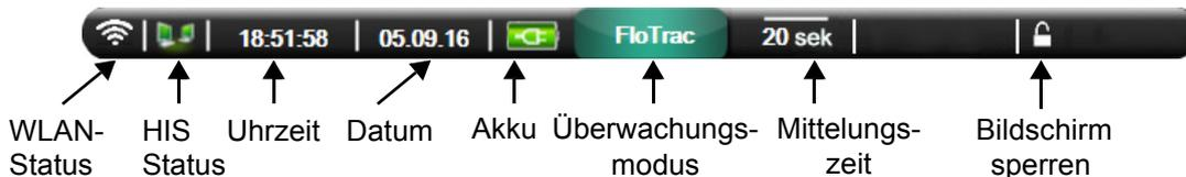
**Abbildung 5-20 Informationsleiste – HemoSphere Druckmesskabel**
