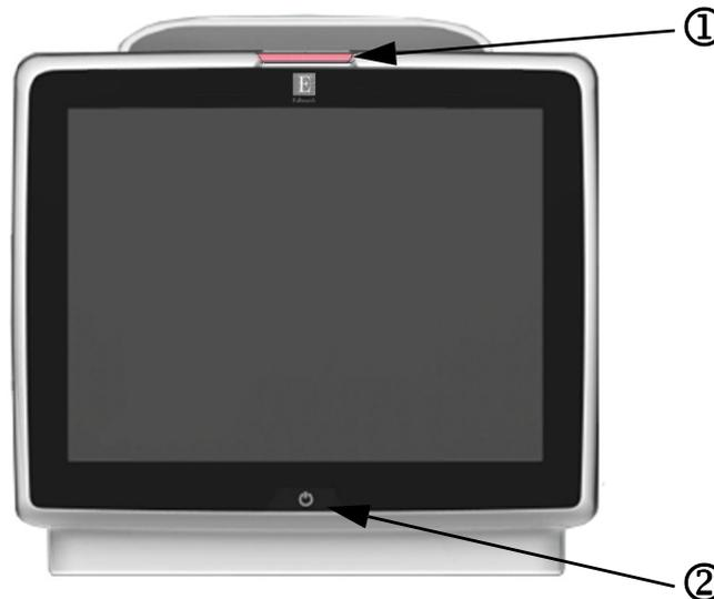
**Figura 13-1 Indicatori LED del monitor avanzato HemoSphere**
