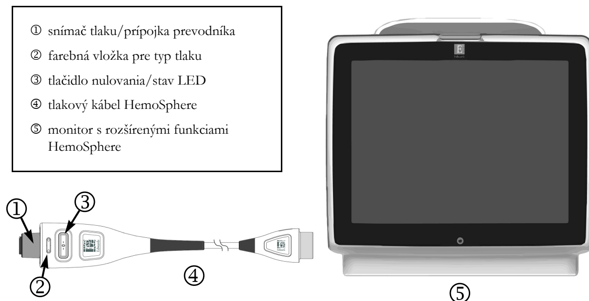
Obrázok 4-2 Prehľad pripojenia tlakového kábla
