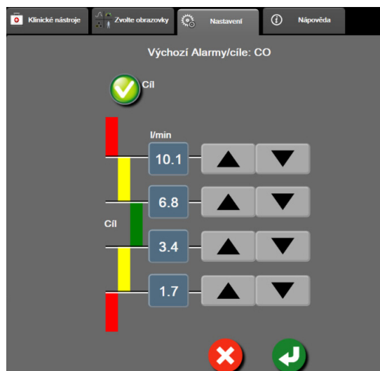
Obrázok 7-2 Nastavenie alarmov a cieľových hodnôt pre jednotlivé parametre
