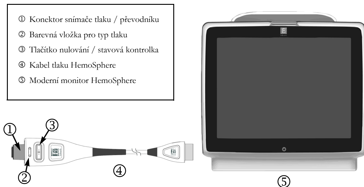
Obrázek 4-2 Přehled připojení kabelu tlaku
