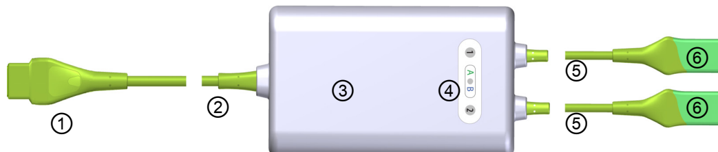
Figure 12-1 Vue de face du module d'oxymétrie tissulaire ForeSight Elite
