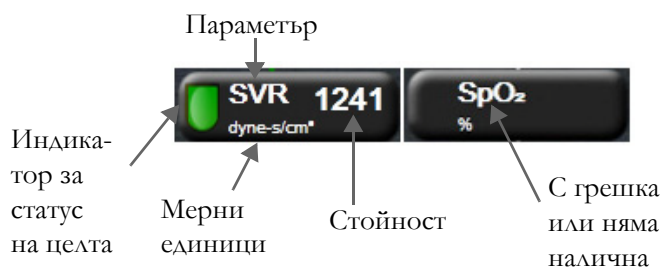
Фигура 5-15 Полета с параметри за физиовръзка
