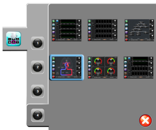
Figur 5-3 Eksempel på overvåkningsskjermbildevalg-vindu
