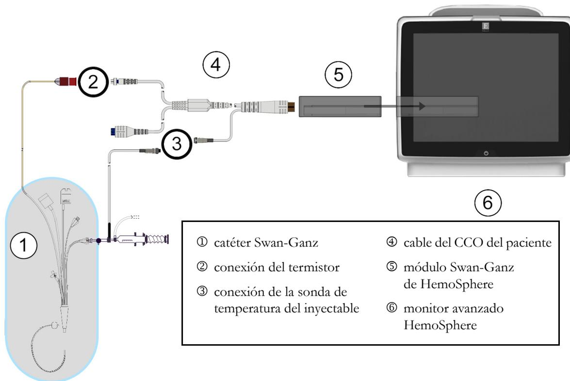
**Figura 9-4 Descripción general de la conexión del GCi**
