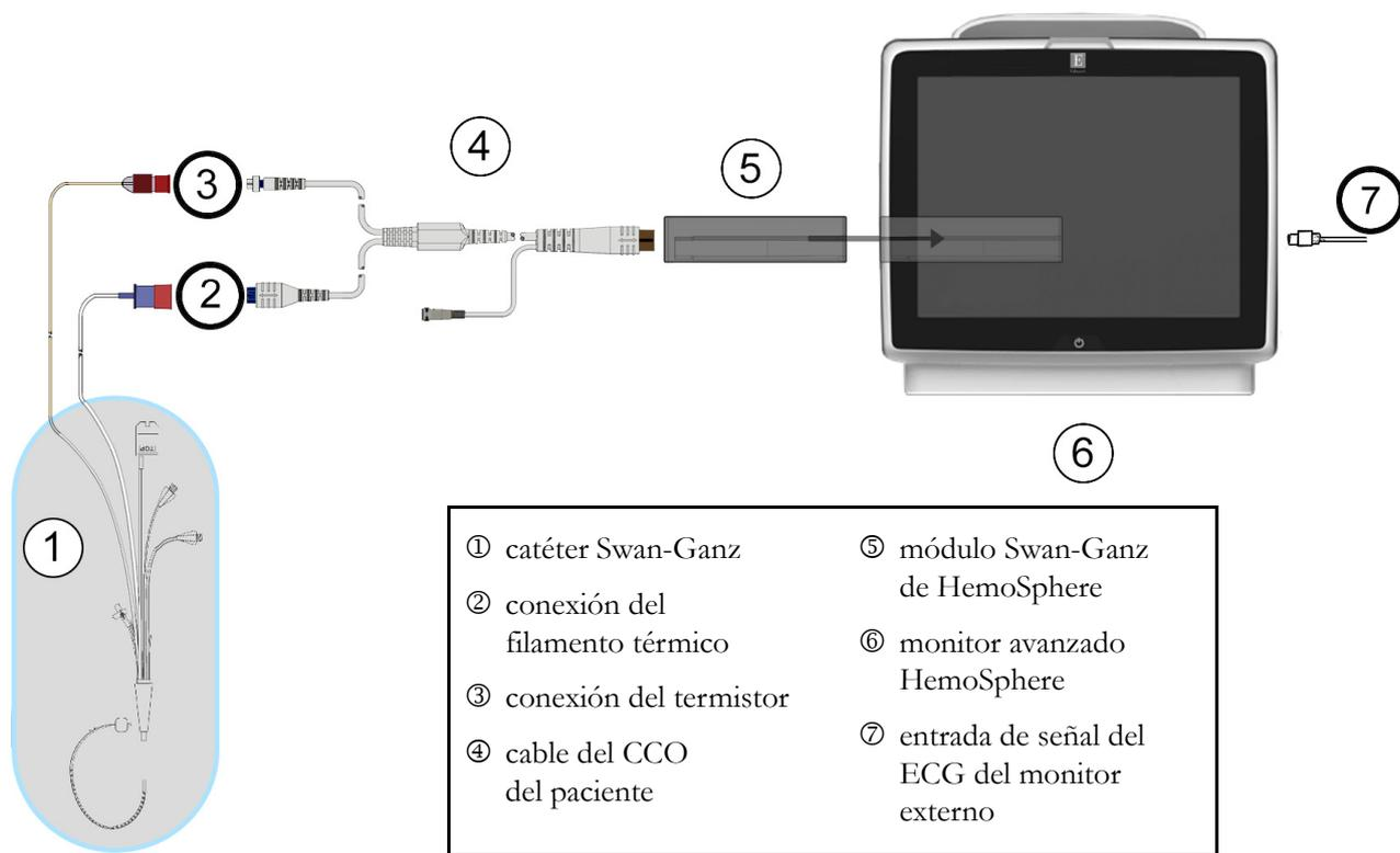
**Figura 9-7 Descripción general de conexiones de VDF/FEVD**
