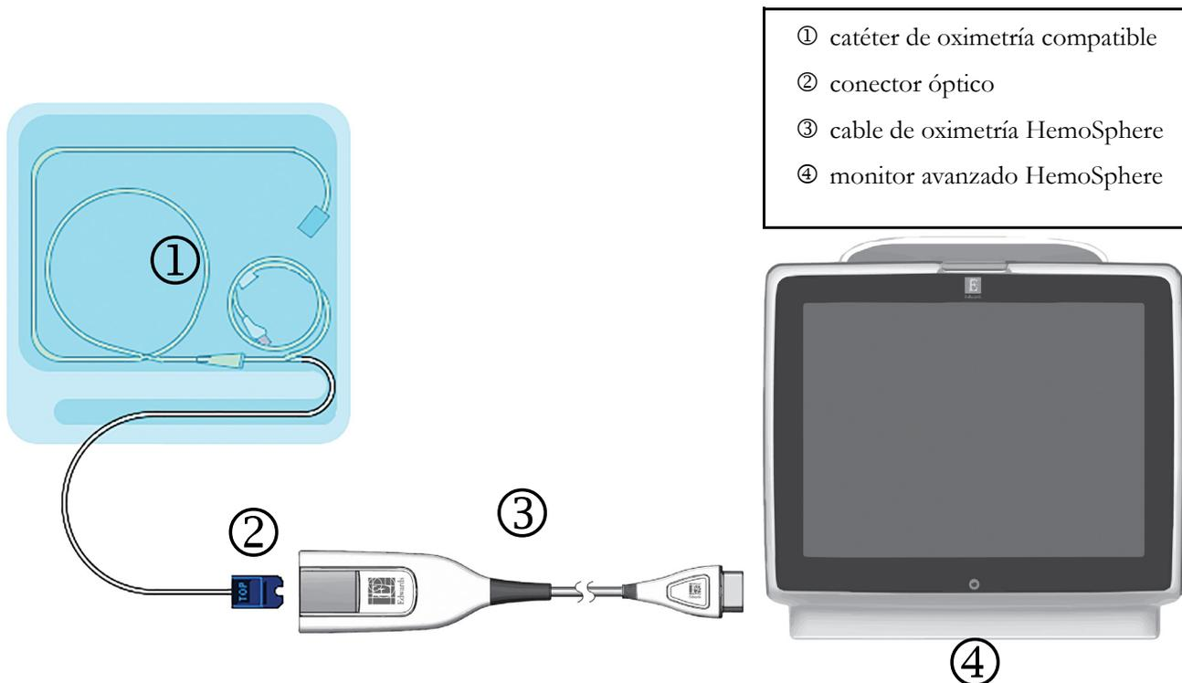
**Figura 10-1 Descripción general de la conexión de oximetría**
