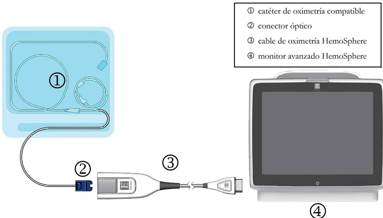
**Figura 4-2 Descripción general de la conexión de oximetría**
