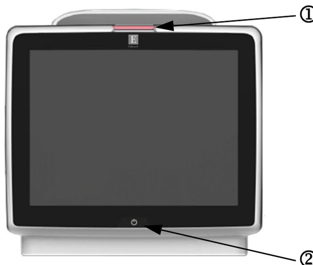
**Figura 15-1** Indicadores LED del monitor avanzado HemoSphere
