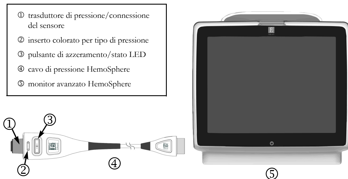
Figura 4-2 Panoramica del cavo di pressione
