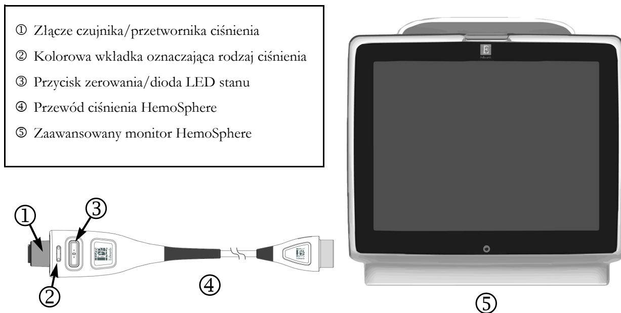
Rysunek 4-2 Opis podłączania przewodu ciśnienia
